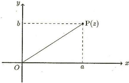
点の座標を、 $OP$ の長さ、 $OP$ と $x$ 軸の間の角 $\theta$ を用いて表す。
